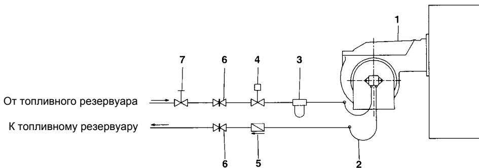
Рис. 6 - Двухтрубная система
