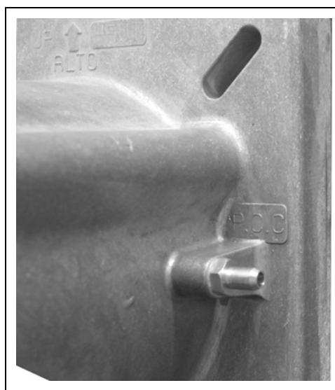
Рис. 13b - Отбор давления в камере сгорания
