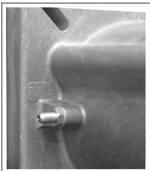
Рис. 13а - Отбор давления воздуха вентилятора
