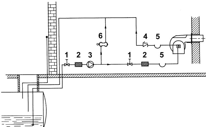
Рис. 5- - Контур подачи топлива всасыванием
